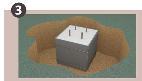
3 L'ouvrage est bétonné. La plaque COFRAVITE® reste en place.
