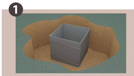
1 La plaque COFRAVITE® est façonnée aux dimensions et cerclée.
