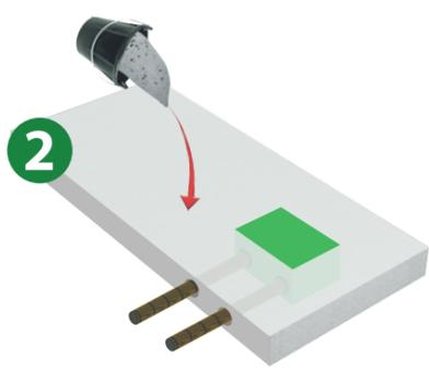
2 Coulage du béton autour de la REZABOITE P. Les gaines sont protégées.
