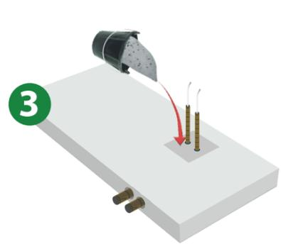
3 Ouverture de la REZABOITE G. Passage des PE, raccordement au réseau et rebouchage de la réservation.
