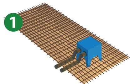
1 Les pieds de la REZABOITE G sont coupés en fonction de l'épaisseur de dalle. Les REZABOITE G reposent sur le fond de coffrage et sont alors ligaturés au treillis. (En Prédalle : les pieds sont repliés et spittés à l'aide d'un feuillard métallique).
