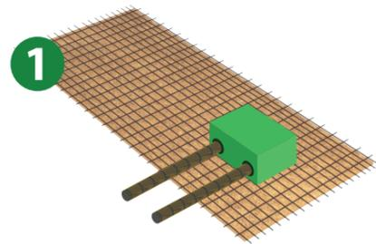
1 Pose des REZABOITE P directement sur le treillis soudé (maintien par ligature). Incorporer les fourreaux / gaines.
