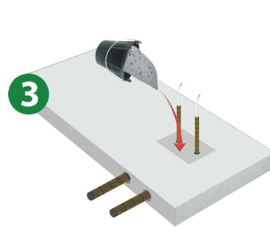
3 Ouverture de la REZABOITE P. Passage des PE, raccordement au réseau et rebouchage de la réservation.
